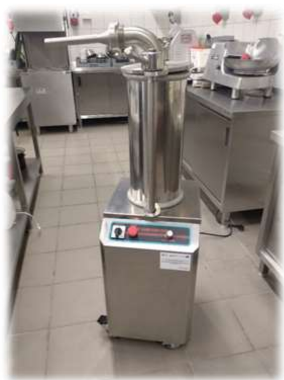
Rys. Nadziewarka hydrauliczna All4tech poj. 25 dm 3
