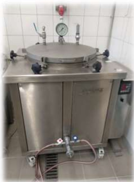
Rys. Autoklaw Jugema z przeciwnieniem oraz możliwością rejestracji dawki cieplnej, poj. 200 dm 3
