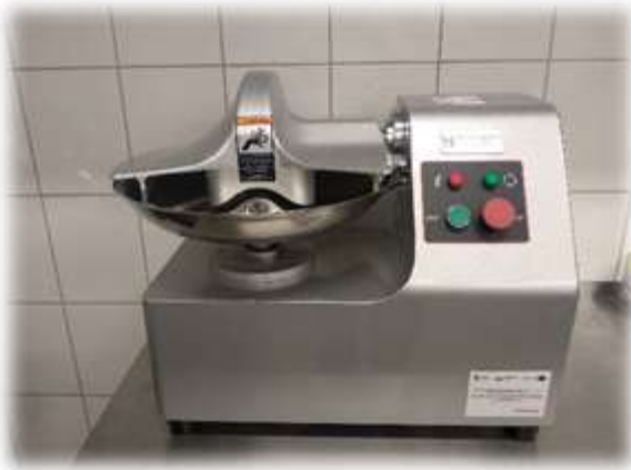
Rys. Kuter misowy o poj. 5 dm 3
