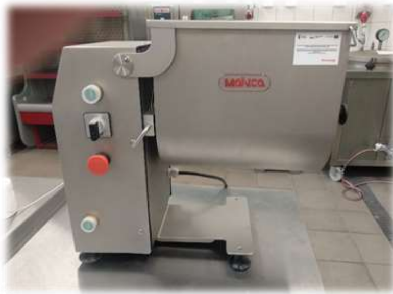
Rys. Mieszalka łopatkowa Mainca o pojemności 20 dm 3
