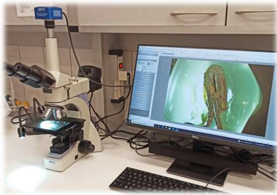
Rys. Mikroskop metalograficzny z wyposażeniem (fot. analiza prawidłowości wykonania podwójnej zakładki)
