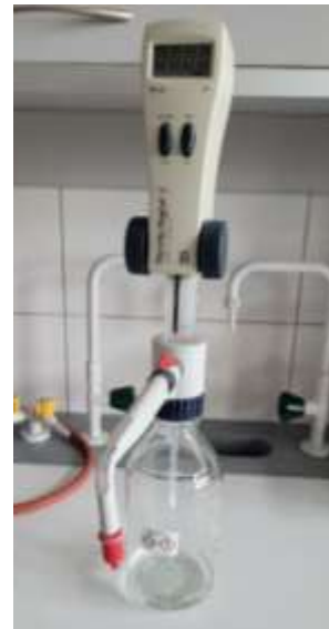
Zestaw do oznaczania zawartości azotu i białek metodą Kjeldahla
