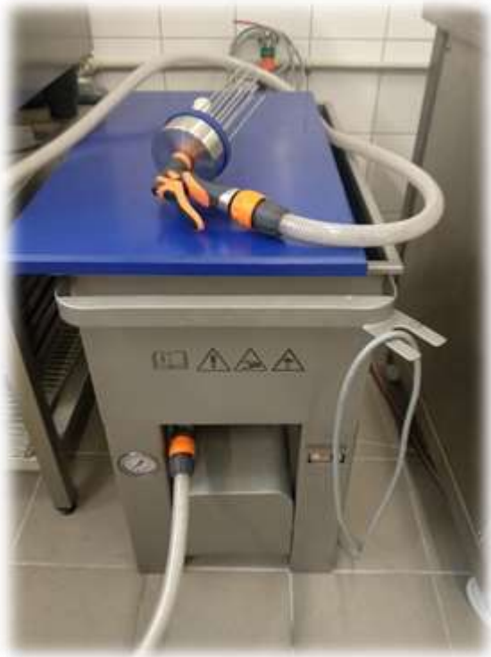
Rys. Nastrzykiwarka ręczna Inwestpol An-11 z obiegiem solanki
