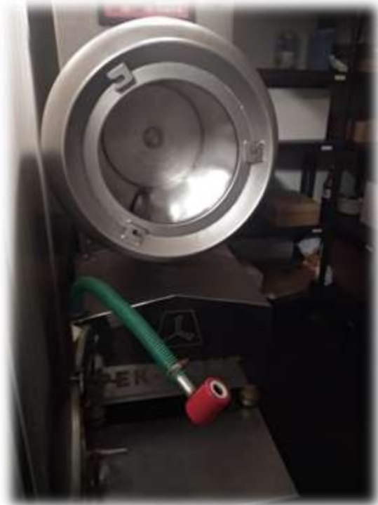
Rys. Masownica próżniowa Pekmont poj. 50 dm 3
