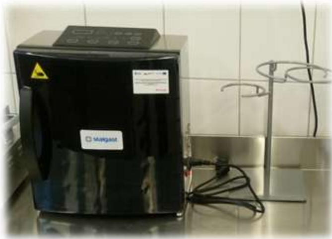
Rys. Pakowarka próżniowa umożliwiająca pakowanie produktów w płynie (maksymalna szerokość zgrzewu 254 mm)
