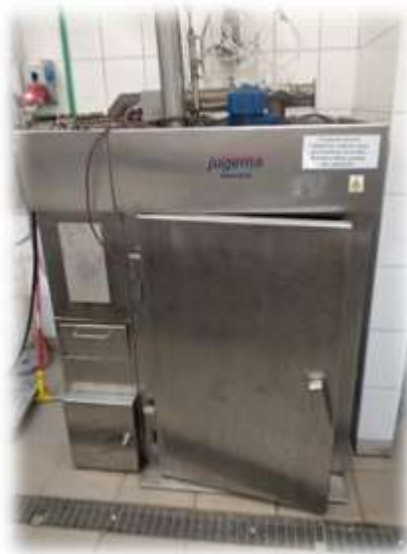
Rys. Laboratoryjna komora wędzarnicza wyposażona w sterowanie automatyczne
