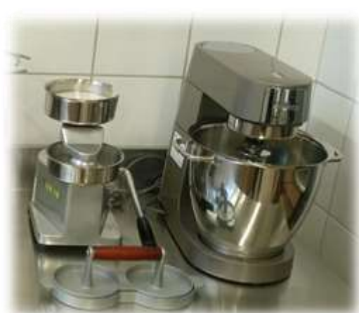
Rys. Prasa do hamburgerów (umożliwia szybkie formowanie hamburgerów o jednakowej średnicy 130 mm) i robot kuchenny Kenwood / Chef XL
