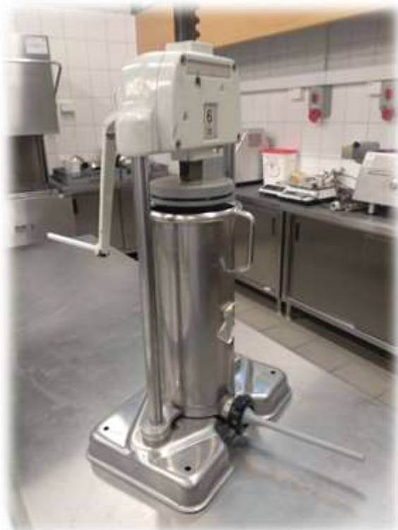
Rys. Nadziewarka ręczna Dick poj. 5 dm 3
