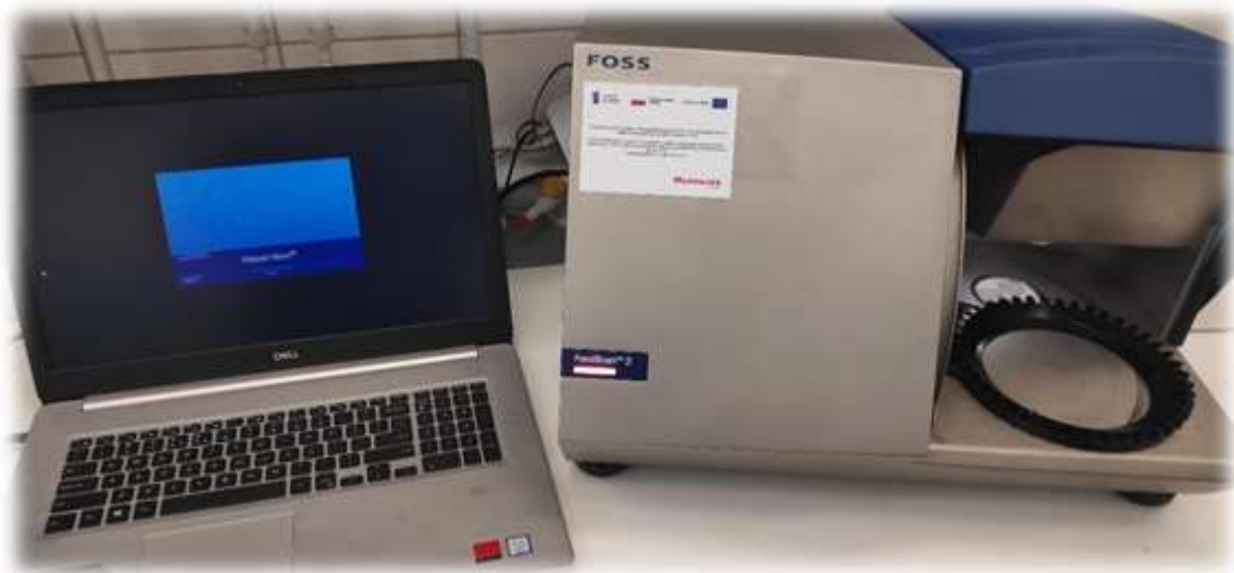
Rys. Analizator FoodScan™ 2- analiza w bliskiej podczerwieni (NIR)
