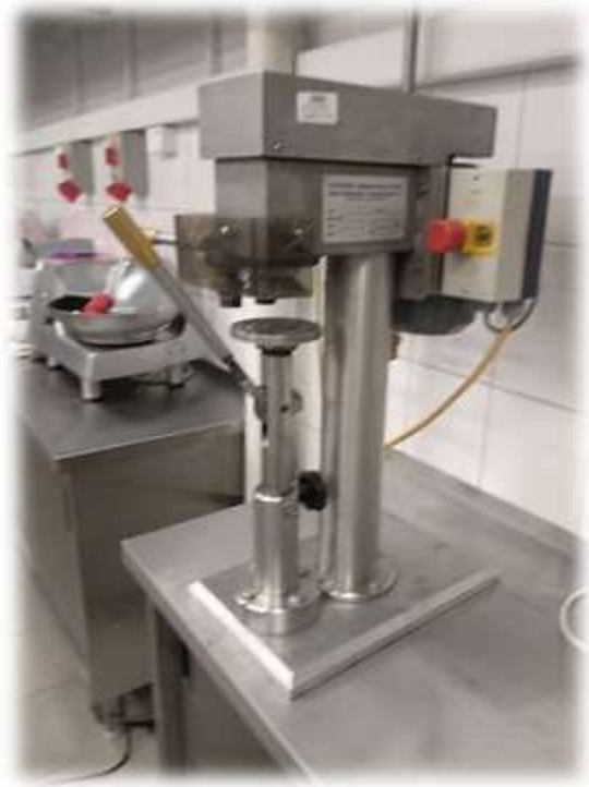
Rys. Półautomatyczna zamykarka do puszek \varnothing 73mm
