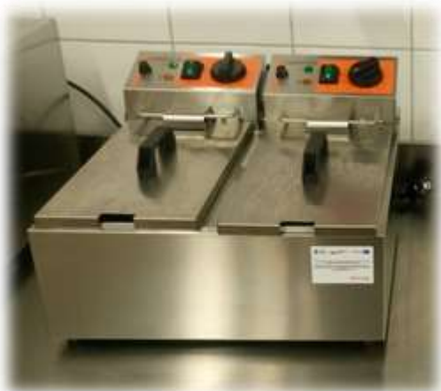
Rys. Frytownica dwukomorowa (pojemność użytkowa 2x3.5 l; regulacja temperatury 60-200°C; system zimnej strefy zapobiegający przypalaniu się resztek żywności)
