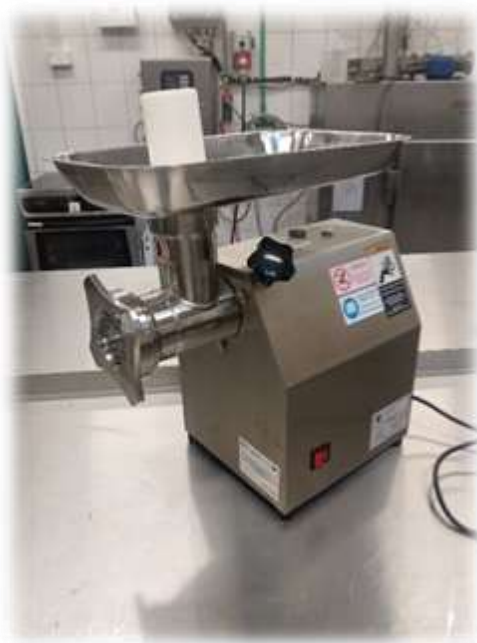
Rys. Wilk o wydajności 120 kg/h
