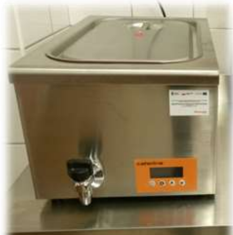
Rys. Urządzenie do gotowania Sous-Vide (pojemność 24 l, zakres ustawień temperatury 5°C - 95°C, równomierna cyrkulacja wody)
