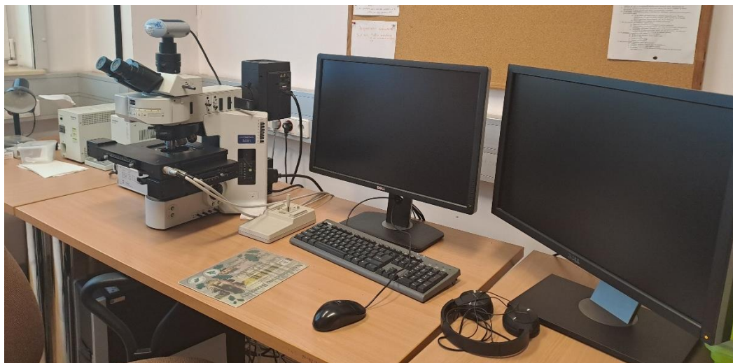
Ryc. SZBL 3. System mikroskopowy Olympus BX61 sprzężony z kamerą i oprogramowaniem Cell P do rejestracji i analizy obrazów mikroskopowych
