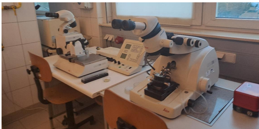
Ryc. SZBL 4. Ultramikrotom Leica EM UC6 z trymerem i łamarką do noży szklanych do przygotowywania ultracienkich skrawków materiału roślinnego
