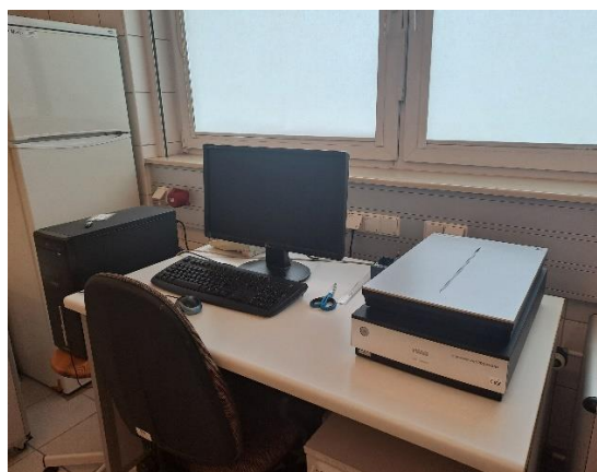
Ryc. SZBL 2. Stanowisko z oprogramowaniem WinDendro. do pozyskiwania i analizy obrazów słoju drewna
