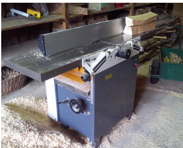
Ryc. KUL 1. Strugarko-grubościówka HP-410/400
