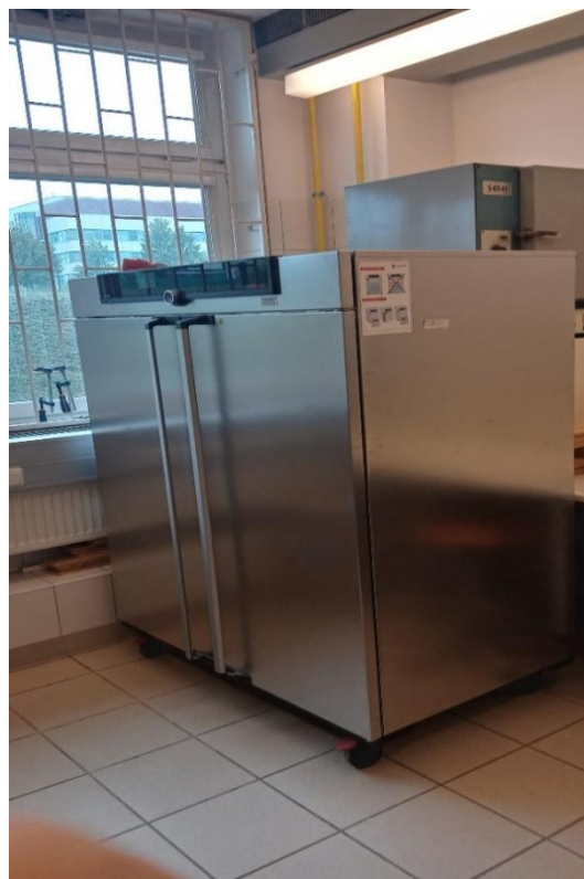
Ryc. KULDiEL 4. Suszarka laboratoryjna Memmert o poj. 750 l
