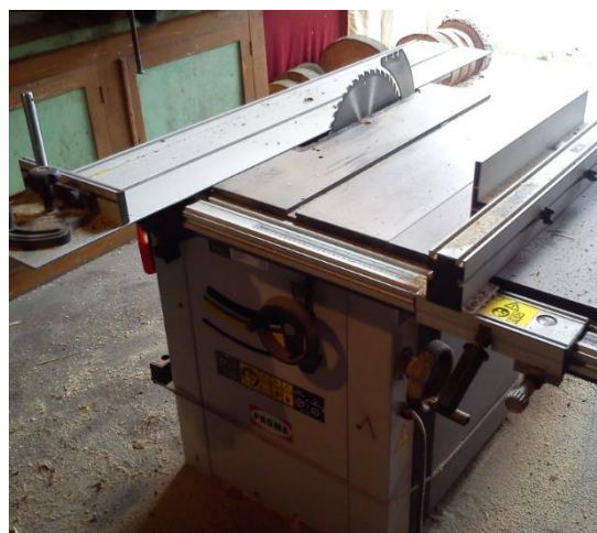
Ryc. KUL 2. Piła tarczowa z podcinakiem PKS-315F
