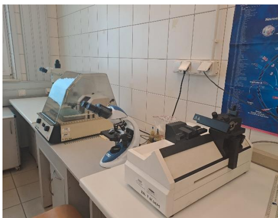
Ryc. SZBL 1. Mikrotom saneczkowy Microm HM 440E do krojenia materiału roślinnego na cienkie skrawki do badań anatomicznych
