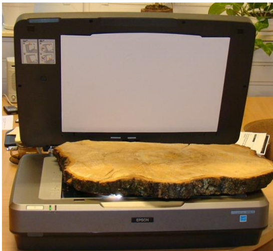
Ryc. KHL 4. Skaner wielkoformatowy do analizy materiału przyrostowego (krążki, wałeczki przyrostowe)
