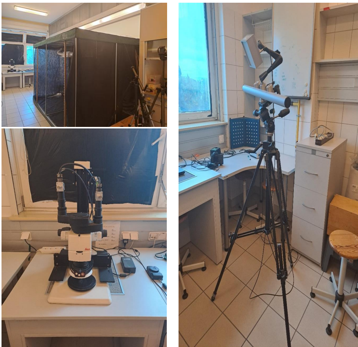
Ryc. SZBL 5. System do rejestracji dynamiki wzrostu i zmian położenia oraz odkształceń organów roślinnych (DIC Dantec Dynamics Model Q400 micro DIC i Diamond Room)
