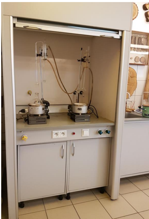
a. Digestorium z aparatem Derynaga do oznaczanie zawartości olejków eterycznych w surowcach roślinnych
