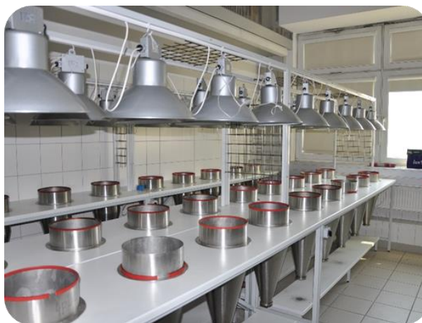
Ryc. KOL 4. Pomieszczenie z fotoeklektorami do wypłaszania fauny glebowej
