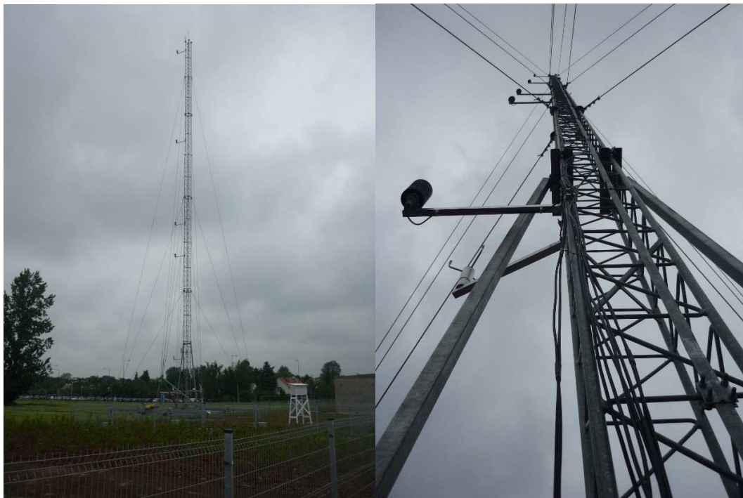
Maszt meteorologiczny: widok ogólny i czujniki do gradientowego pomiaru temperatury i wilgotności powietrza
